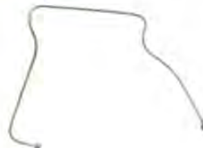
Tubería rígida alimentación de aceite a cojinete árbol de levas
