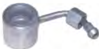
Tubería lubricación de balancines
