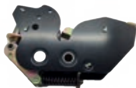
Cerradura bascula. cabina S-4 - SD-C009 1383496
