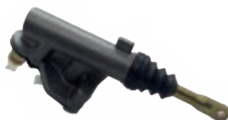
Cilindro maestro embrague S-5 1927829 - FA8913
